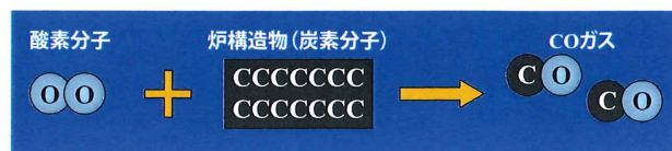
図 2-2 グラファイト系炉内構造物の役割
