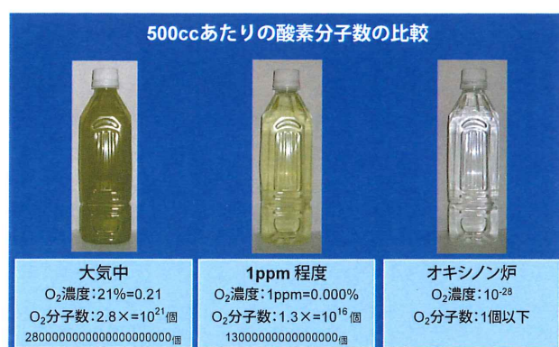
図 2-1 オキシノン® 炉内の酸素量のイメージ (500ccあたりの酸素分子数の比較)
